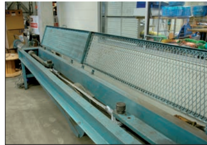
Horisontell dragbänk för provbelastning av lyftredskap såsom ställinor, kätting etc.
