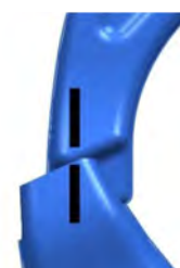
Bild 7: Deformationsgräns. (skadat, dags för reserv eller demolering)
