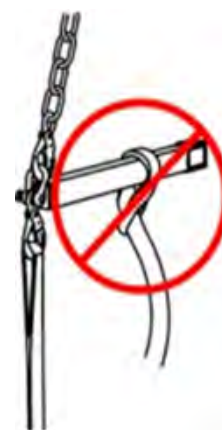
Bild 8: Fastsättning på någon annat ställe än fästpunkterna, är absolut förbjuden!
