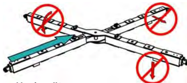
Figur 9 : Endast centriska tryckkrafter tillåtna
